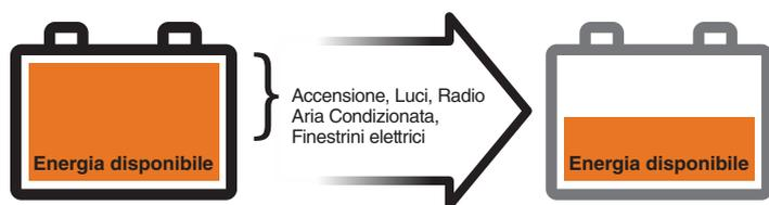
Più accessori sono collegati e utilizzati, maggiore sarà la velocità di scarica della batteria.
